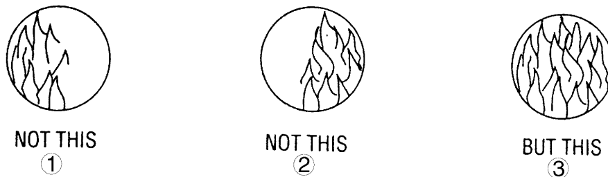
Рис. 4. Пламя должно полностью закрывать отверстие для наблюдения
