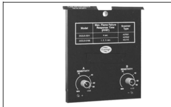
Mit Hilfe eines Fernmeßgeräts (siehe unter „Zubehör“ auf Seite 14) oder eines Voltmeters mit 20.000 Ohm pro Volt auf einer 3 Volt Gleichspannungs-Skala kann der Pegel des Flammensignals festgestellt werden. Das Meßgerät wird an die Prüfbuchsen auf der Frontplatte des Flammensignal-Verstärkermoduls oder an die Klemmen 15 und C/13 angeschlossen.
