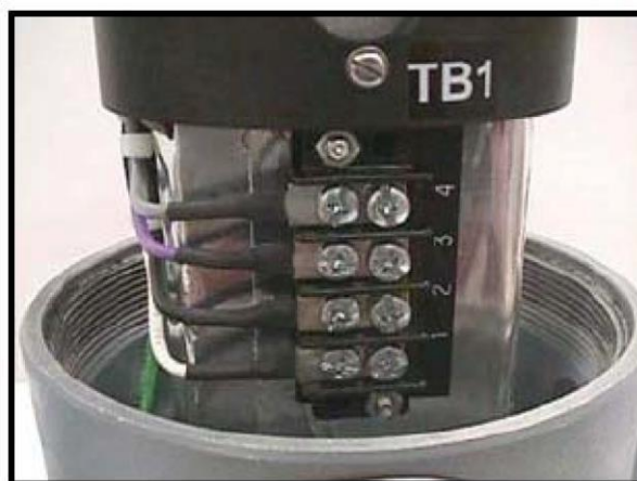
РИСУНОК 9 ЭЛЕКТРИЧЕСКИЕ ПОДКЛЮЧЕНИЯ ДАТЧИКА PHOENIX МОДЕЛИ СЕХ
