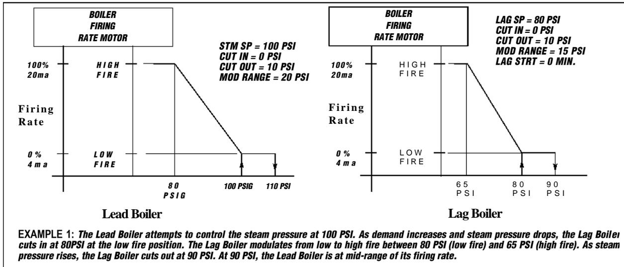
**FIGURE 15. LEAD/LAG BOILER OPERATION EXAMPLE 2**
