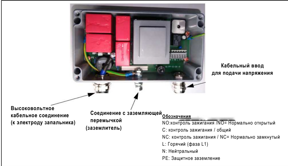
Рисунок 4 Электрическое соединение высокоэнергетического запального устройства HE-PP-12
