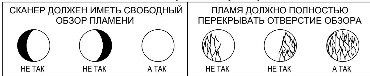
*Примечание: Так как нефтяные и газовые факелы пламени излучают большее количество ультрафиолетовой энергии от ядра пламени, чем на краях пламени, то этот факт должен учитываться при установке просвета сканера.*
