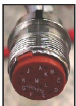
Oranssi läpivienti asennettuna runkoon
