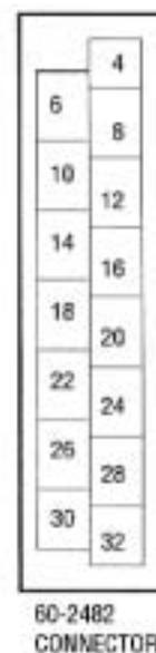
1. Conectar solamente una línea de voltaje del scanner a cada terminal. (La alimentación para los scanners de bajo voltaje se suministra a través del amplificador 25SU3).
