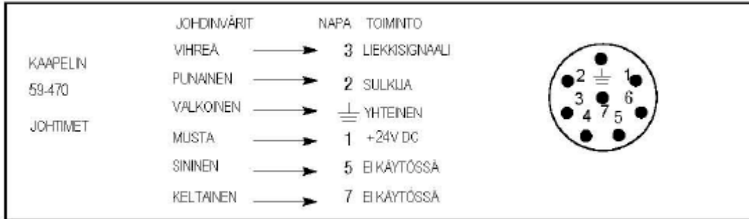
KUVA 14. PIKALIITTIMEN PISTIKEJÄRJESTYS
