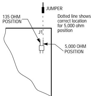
JUMPER ON CORNER OF LOWER BOARD OF CES1000 CONTROLLER (SHIPPED IN 5,000 OHM POSITION)
