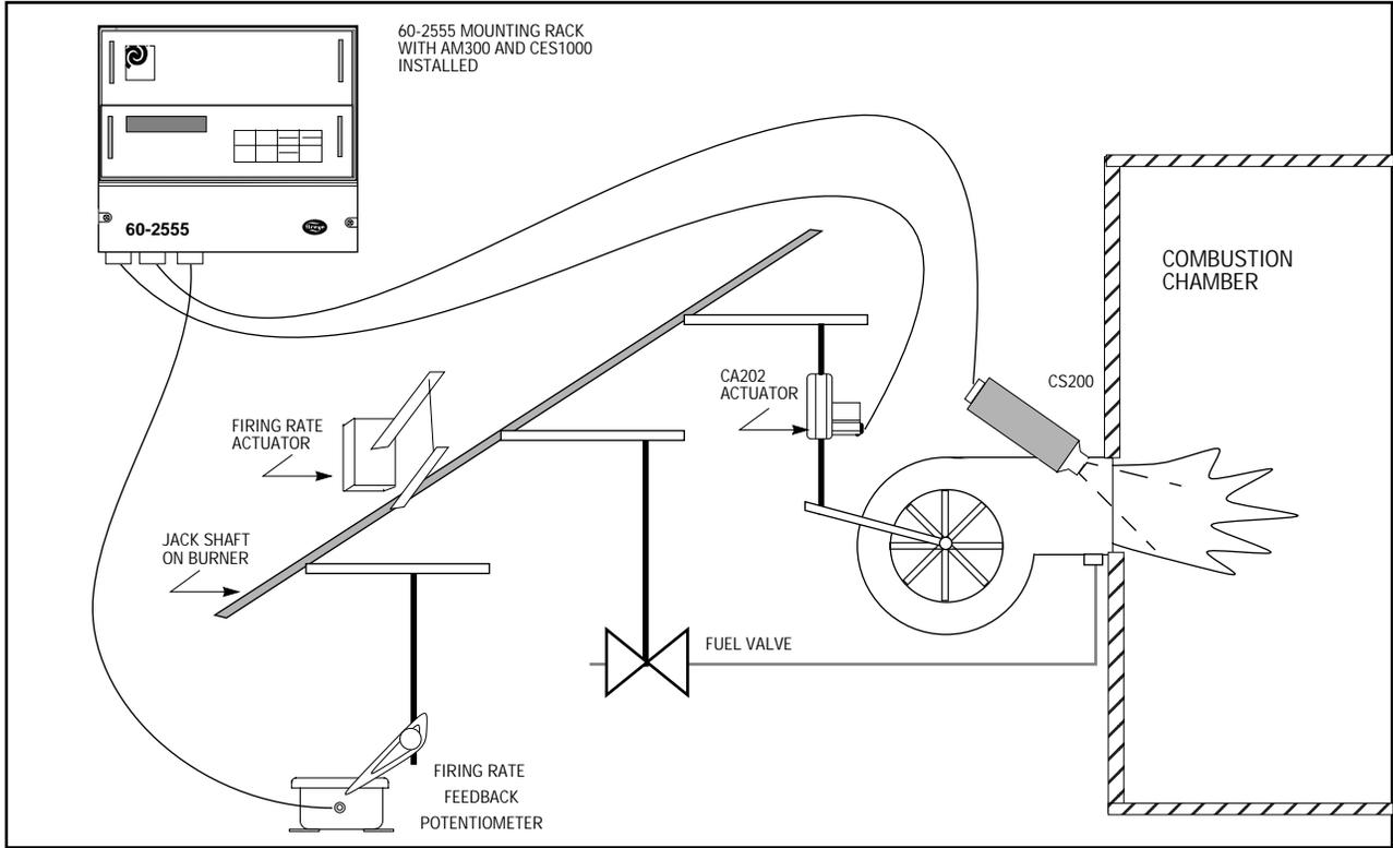
**FIGURE 3. CONFIGURATIONS FOR FOCUS COMBUSTION EFFICIENCY SYSTEM**
