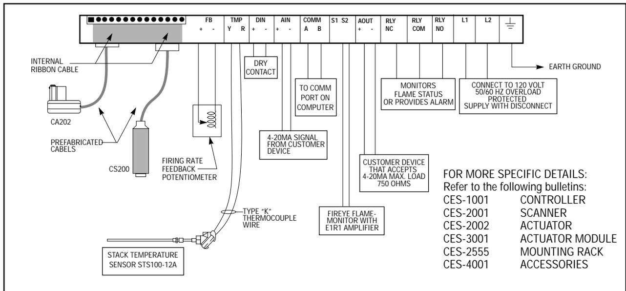
**FIGURE 2. FOCUS SYSTEM INSTALLED ON A JACK SHAFT OPERATED BURNER**
