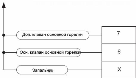
**ПРЕДУПРЕЖДЕНИЕ:** Все ключи безопасности должны иметь соответствующую сертификацию и быть подключены непосредственно к схеме системы контроля пламени. Применение электронных ключей в схемах блокировки может стать причиной непредсказуемой работы.
