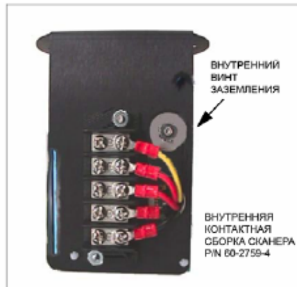
РИСУНОК 4. ВНУТРЕННИЕ ПОДКЛЮЧЕНИЯ СКАНЕРОВ SIMPLICITY МОДЕЛИ 65UV5-1004 СЕХ
