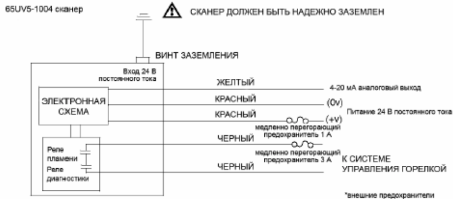
СХЕМА ВНЕШНИХ ПОДКЛЮЧЕНИЙ СКАНЕРА
